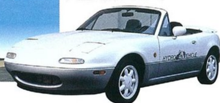
●水素自動車の実現化の鍵を握るのが水素ステーションの建設や供給網の整備といった社会インフラ。その他に開発されている次世代燃料との兼ね合いや安全性の確保も含めて、まだまだ超えなければならないハードルは多い。下の写真は水素ロータリー搭載の初代ロードスター。
