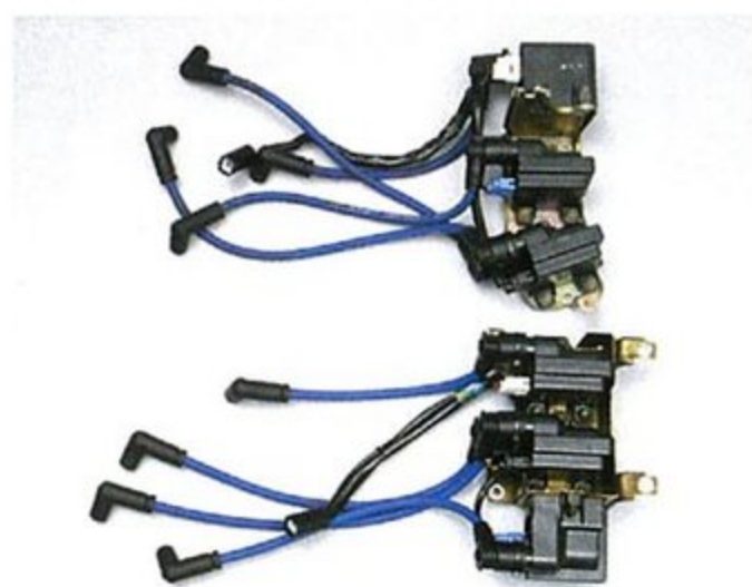
●上がⅣ～Ⅵ型（後期）、下がⅠ～Ⅲ型（前期）のコイル。マイナーチェンジでレイアウトが変更され、それぞれの間隔が広がった。ということは「熱」もトラブルの原因だろう。
