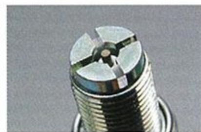
●こちらは新品。中心電極の先端が丸くなったら交換時期だ。接地電極の方も角が少しずつ丸くなる。定期的にチェックしていればその「減り具合」もわかる。
