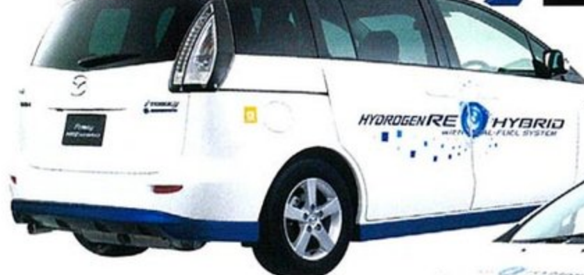
●横置きFFレイアウト水素ロータリーエンジンを搭載したプレマシーハイドロジェンRE。ガソリンと水素の両方が使えるデュアルフューエルシステムを採用。ハイブリッドシステムによって、発進と加速時にはレスポンスを高める。
