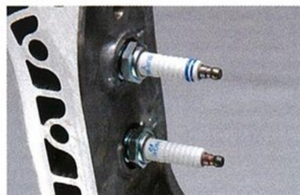
●これぞマツダ・オリジナルの象徴である「2プラグ」。2段階点火方式により、ロータリーは実用性を手に入れたと言っても過言ではない。
