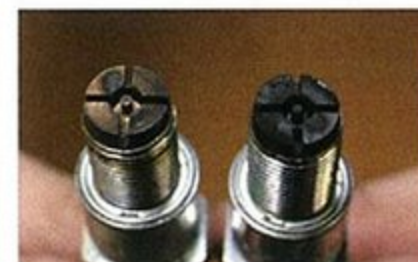
●オイルの燃えカスやカーボンが付着しやすいのがロータリーの特徴。これが着火不良の原因になる。
