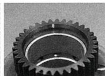
●写真右がフロント用、左がリア用だ。ギヤの歯数は34枚（ローター側は51枚）。ギヤカットは左右対称の形状となっており端面は面取り加工される。
