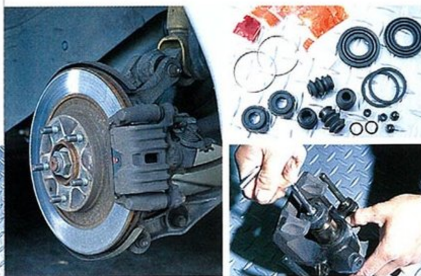
●ピストンツールはシール交換時にも役立つ。ピストンシール、ダストシールは重要なパーツ。パッド交換時には、最低でもダストシールの亀裂の有無だけはチェックしよう。
