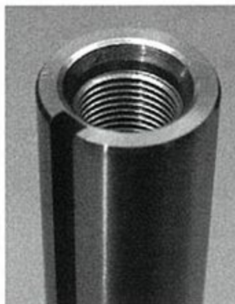
●先端部に「サーモベレット」を内蔵。これにより暖機が必要な低温時にはオイルジェットは作動しない仕組み。
