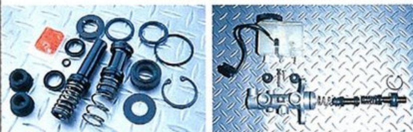
●シール交換はフルードのエア抜き作業（入れ替え）をともなうので、プロに依頼した方がいいだろう。ついでにリザーバータンクのシールも交換してもらおう。
