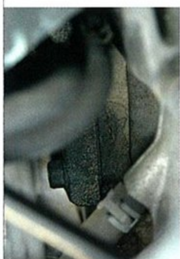
●「インマニガスケットの脱落」が起きている部分のアップ。エンジン降ろしの動機にはなる。
