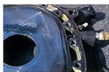
●こちらはブローしたエンジンのサイドハウジング。かなりキズだらけだが、それでもエンジンがパワーダウンを起こしながらも動いてしまうことがある。
